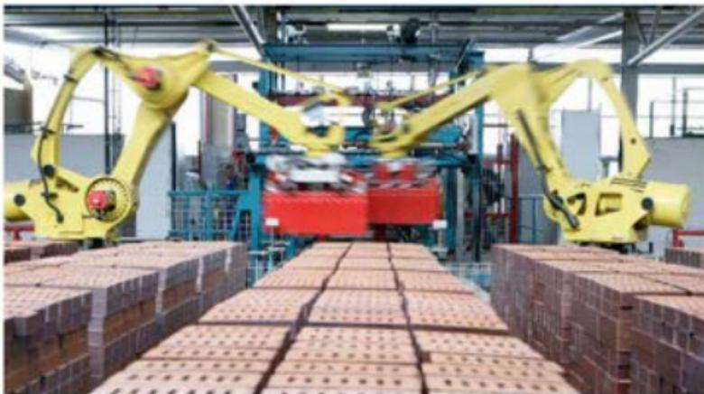
In der Janinhoff-Klinkermanufaktur in Münster werden Ziegel effizienter und mit weniger THG-Emissionen hergestellt. Schrittweise soll zudem Erdgas durch Wasserstoff ersetzt werden. Hier übernimmt Robotertechnik in der Absetzanlage das Abladen gebrannter Ziegel. Foto: P. Wittendorff
